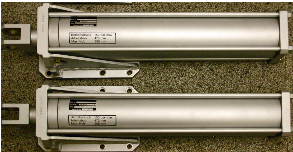
Einfachwirkender Pneumatikzylinder eingesetzt als Pneumatikfeder Betriebsdruck 150bar
